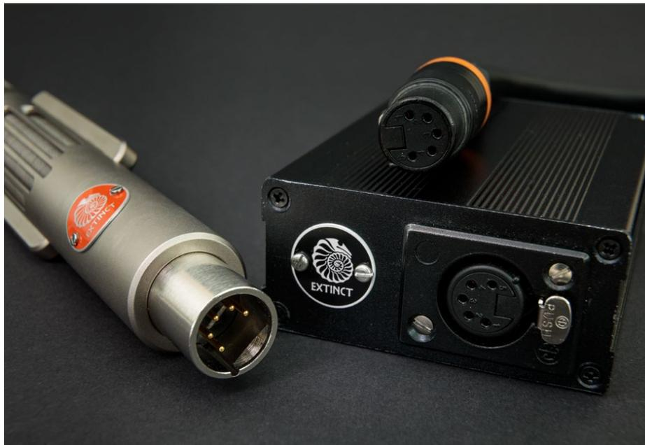
Der fünfpolige Ausgang des Valkyr Stereomikrofons wird mithilfe einer Splitter-Box in zwei Monosignale (XLR) aufgeteilt.
